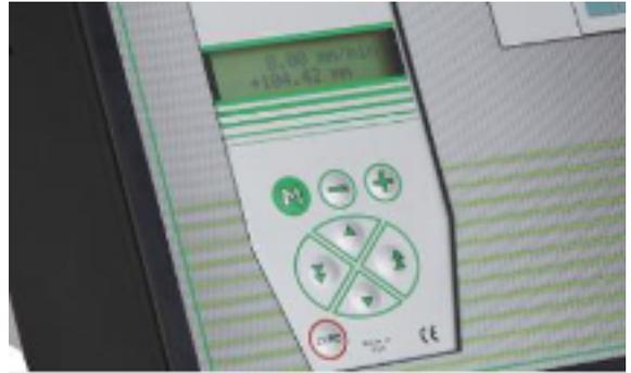
El comando manual del motor permite un desplazamiento suave del travesaño para ponerse en posición antes de comenzar las mediciones o para ajustar las primeras pruebas.
